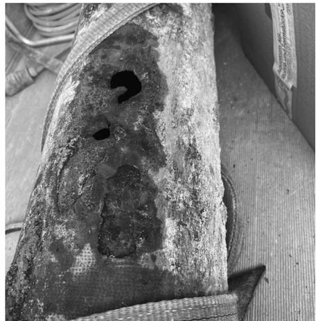
Schieber zu, so dass der Wasserstrom fast versiegte. Auch hier wurde die Leitung freigelegt. Dieses Rohr wies an der Bruchstelle jedoch starke Korrosion auf, so dass ein Stück Leitung ersetzt wurde.
